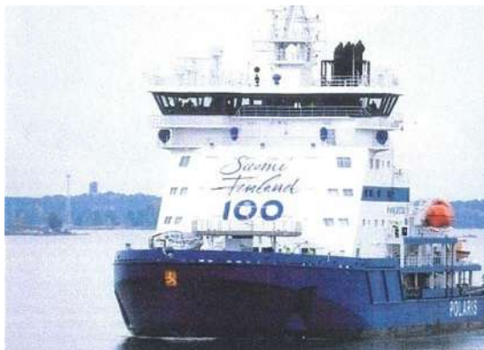
POLARIS. Det statliga isbrytarbolaget Arctica Ab emottog LNG-isbrytaren i november 2016. Enligt befähavare Pasi Järvelin i vissa situationer lika lätt att styra som en mindre båt med aktersnurra.
